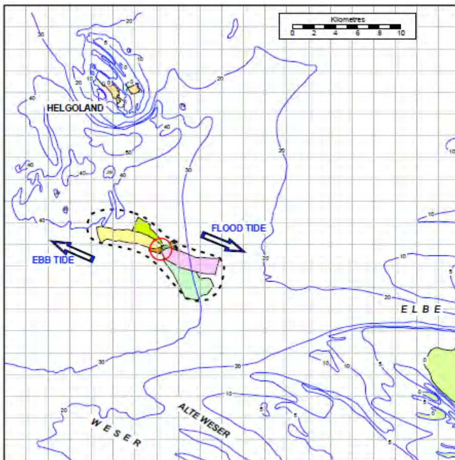
Abbildung A 3-1 Ausbreitungsfelder der Verdriftungswolken während der ADCP-Kampagne 2005. Der abgebildete Bereich zeigt die bei den jeweiligen Messungen insgesamt gemessene Fläche. Diese ist größer als die messbare Schwebstoffwolke.
