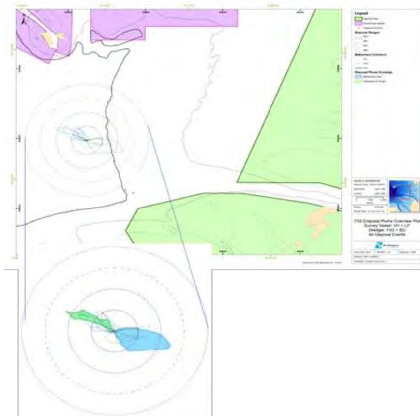
Abbildung 4-4 Ausbreitungsfelder der Verdriftungswolken während der ADCP-Kampagne 2016. Eingefärbt sind die längsten Verdriftungswege der Hopperbagger Bartholomeu Dias (blau) und Francesco di Giorgio (grün). Kreisentfernungen entsprechen 2-, 4-, 6- und 8-km Radius. (Wallingford, 2017, s. auch Abbildung in Anlage A 3-2)
